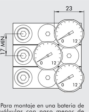
Para montaje en una batería de válvulas con paso menor de 23mm, alternar la posición de los manómetros.
