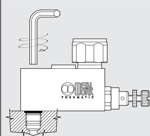
Fijación del reductor a la válvula
